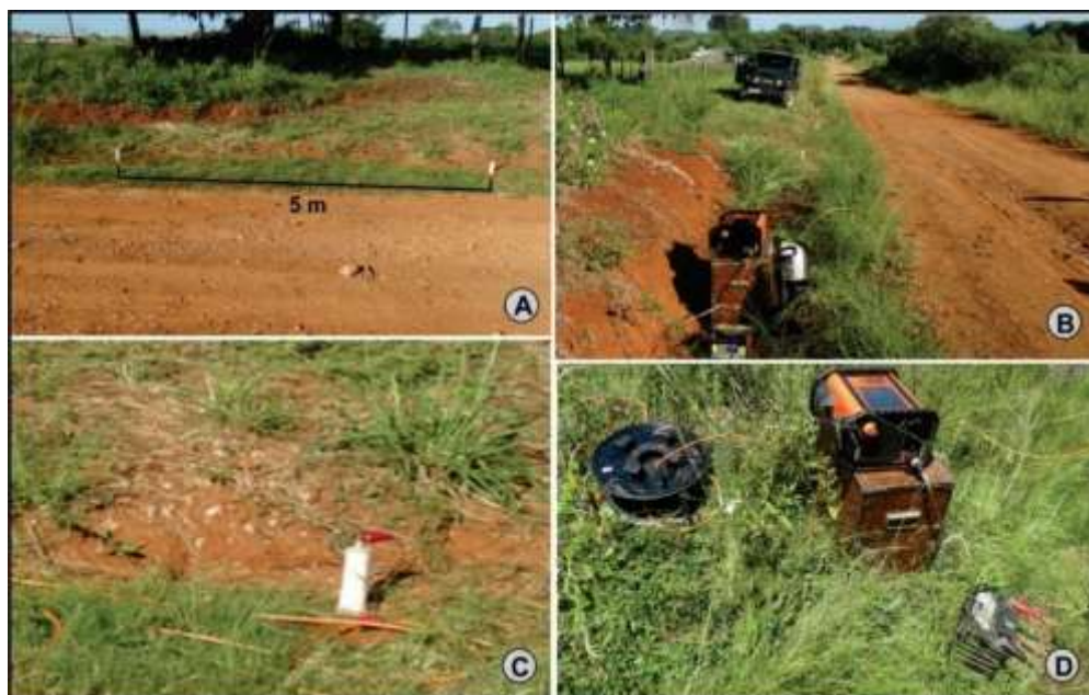
Figura 10: A) Configuração dos eletrodos em campo. B) Eletrodos posicionados para aquisição de dados da L2. C) Eletrodo não-polarizável preenchido por solução de \text{CuSO}_4 . D) Resistivímetro Terrameter LS utilizado na aquisição dos dados.
