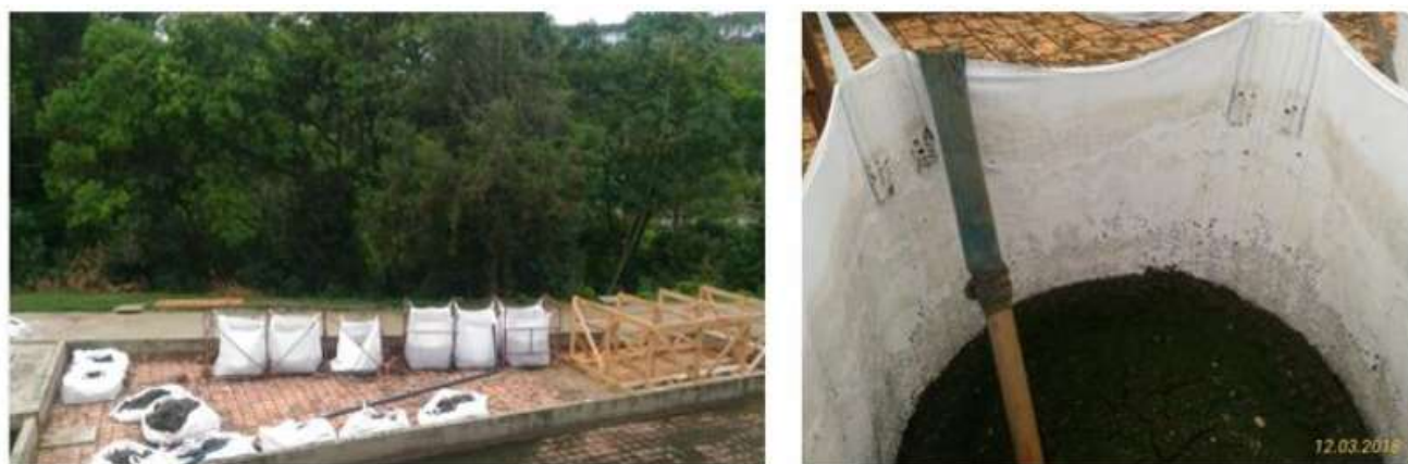
Figura 9 – Desaguamento de lodo de processo físico-químico.
