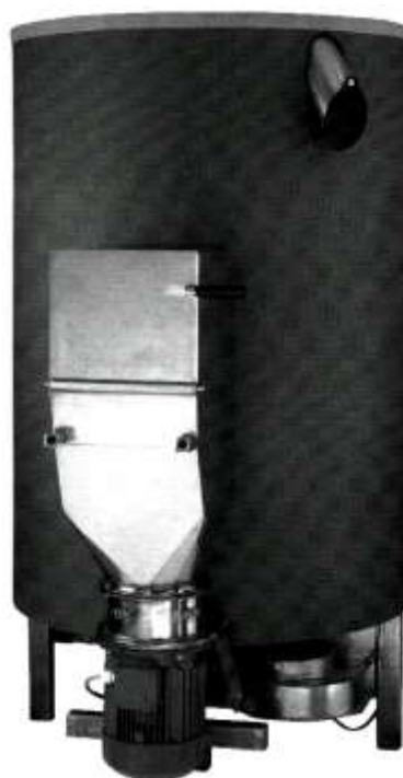
Figura 2: Destaque dos principais componentes do Reator Aeróbio de Aeração Forçada e Fluxo Ascendente para a compostagem de resíduos orgânicos.
