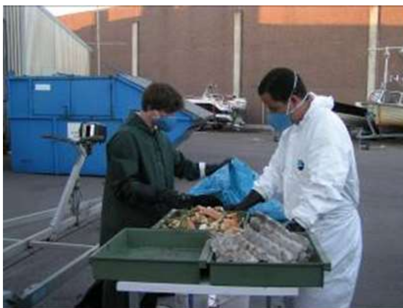
Figura 3: Separação e pesagem manual das frações biodegradáveis e não biodegradáveis do resíduo sólido proveniente de três restaurantes.
