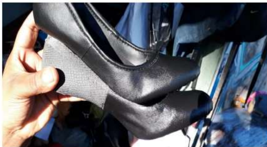
Figura 11. Suproduto OE de coloração preta testado no sapato inferior comparado com produto usado pelo sapateiro no seu dia a dia representado pelo sapato superior (Acervo Próprio)
