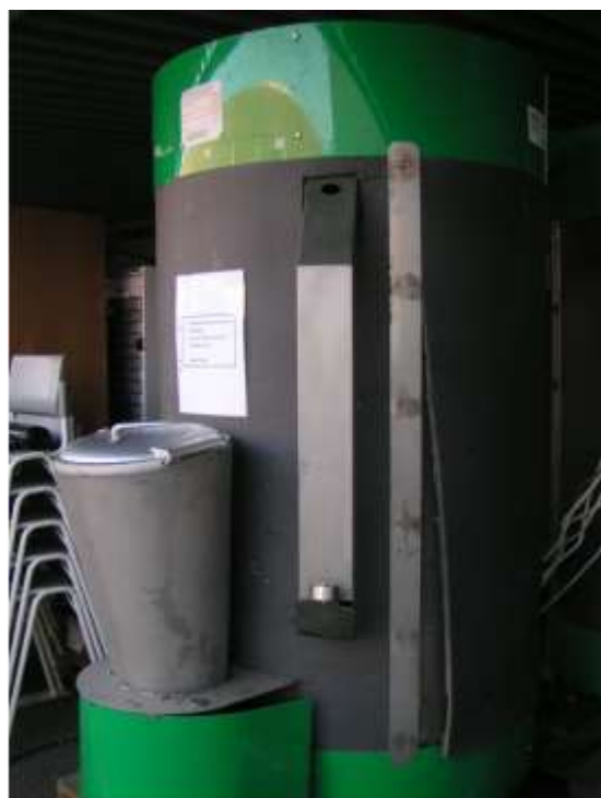
Figura 1: Reator Aeróbio de Aeração Forçada e Fluxo Ascendente para a compostagem de resíduos orgânicos.
