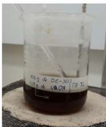
Figura 7. Fim da reação química com catalisador alcalino. (Acervo próprio)
