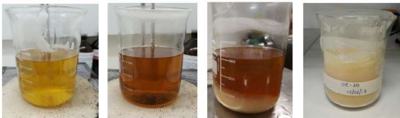
Figura 5. Reagentes sob aquecimento, fim da reação química e solidificação do produto após atingir temperatura ambiente. (Acervo próprio)
