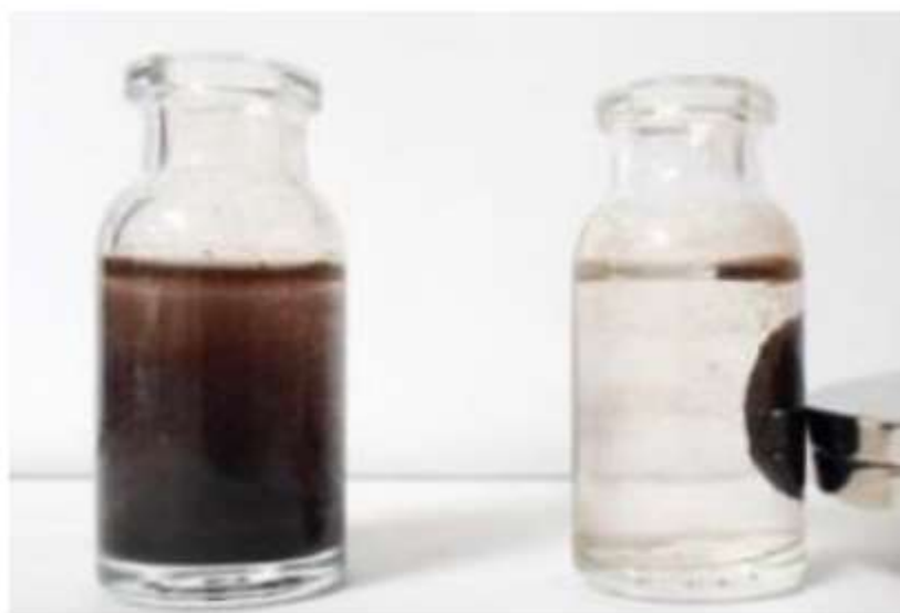
Figura 3 - Partículas em suspensão em uma solução de cobre (esquerda) e partícula atraída pela força magnética (direita)
