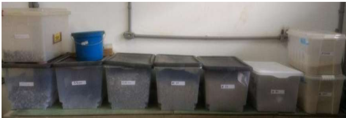
Figura 3.19 – Escória de ferroníquel separada por frações granulométricas.
