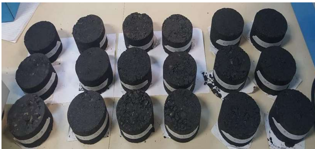
Figura 3.14 – CP's com teores de asfalto de 4,0%, 4,5%, 5,0%, 5,5%, 6,0% e 6,5 %.
