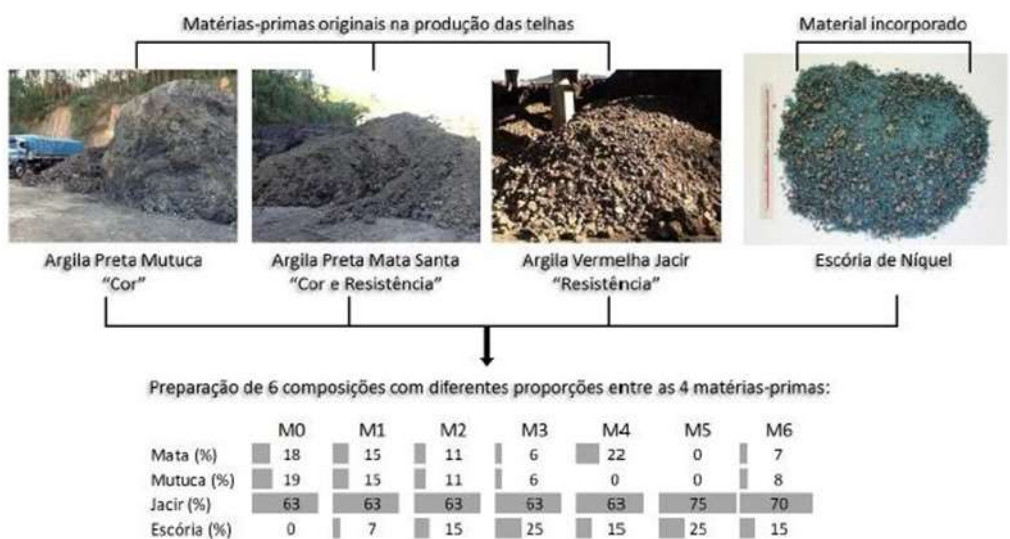
Figura 2.13 - Detalhes das matérias-primas utilizadas na fabricação de telhas (Innocentini et al., 2016).
