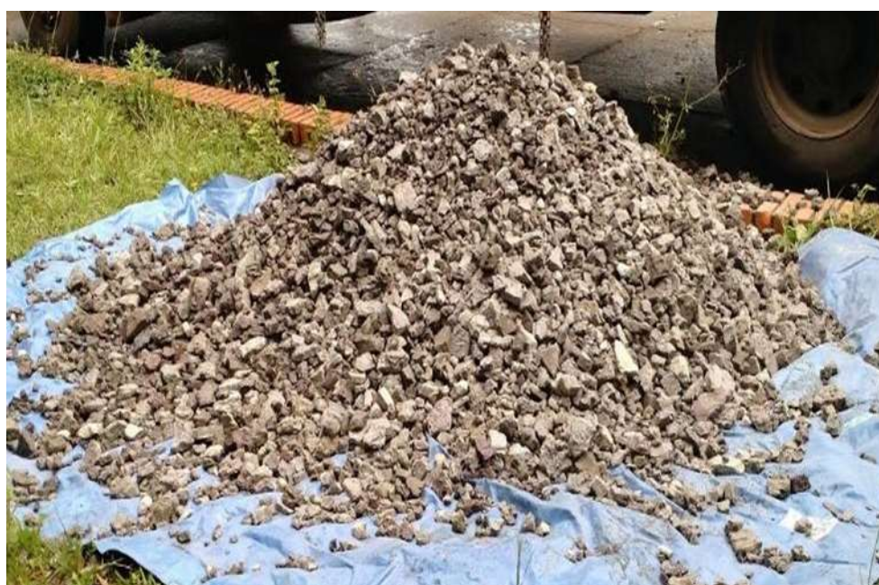
Figura 3.4 – Escória de ferroníquel recebida no Laboratório de Ferrovias e Asfalto.
