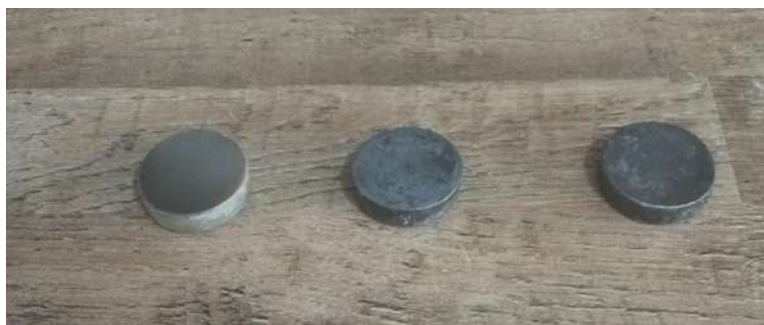
Figura 3.11 – Detalhe das pastilhas preparadas para ensaio de Microscopia Eletrônica de Varredura.
