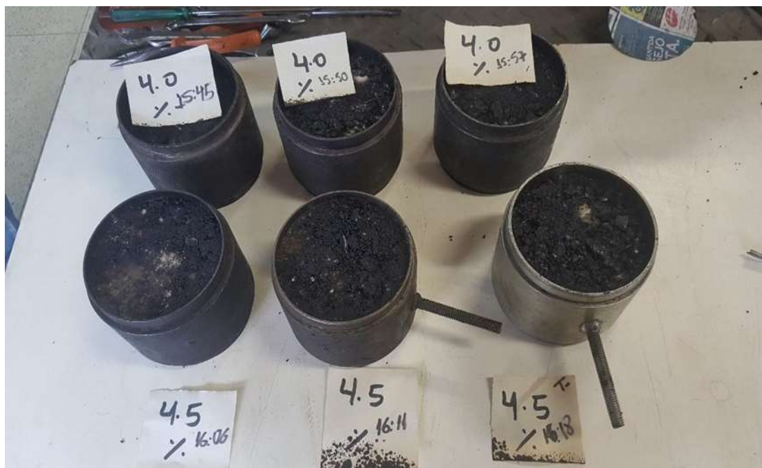
Figura 3.16 – Corpos de prova após compactação.
