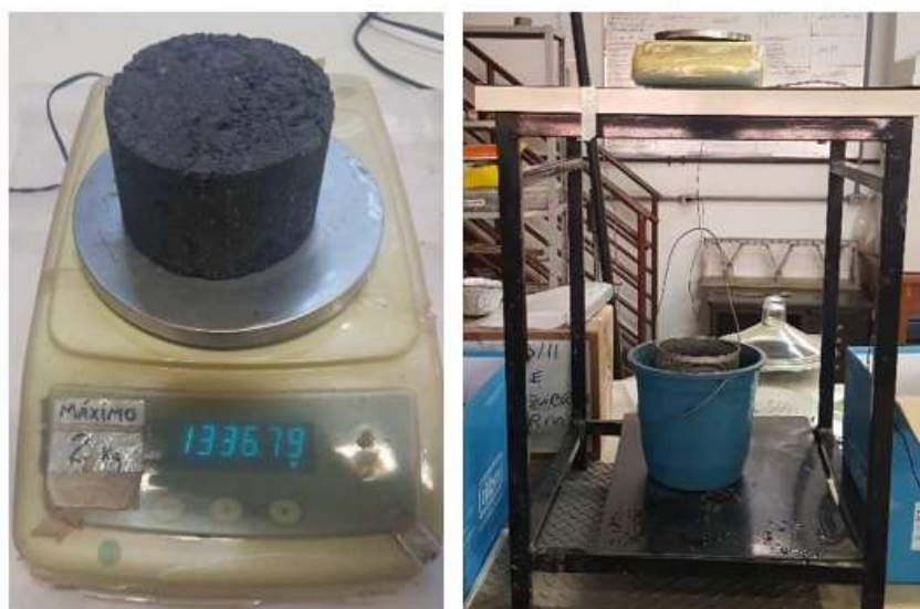
Figura 3.18 – Obtenção da massa seca e da massa submersa em água dos CP's.
