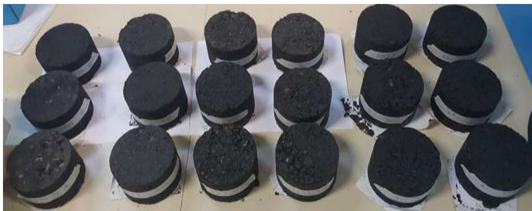
Figura 5.4 – Aspecto dos corpos de prova após moldagem.
