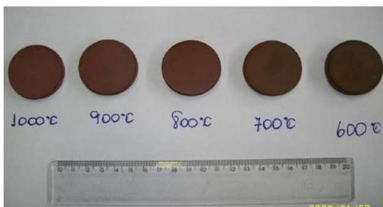
Figura 2.12 – Corpos de prova submetidos a temperaturas variando de 600 °C a 1000 °C. Fonte: Lima e Zampieron (2009)
