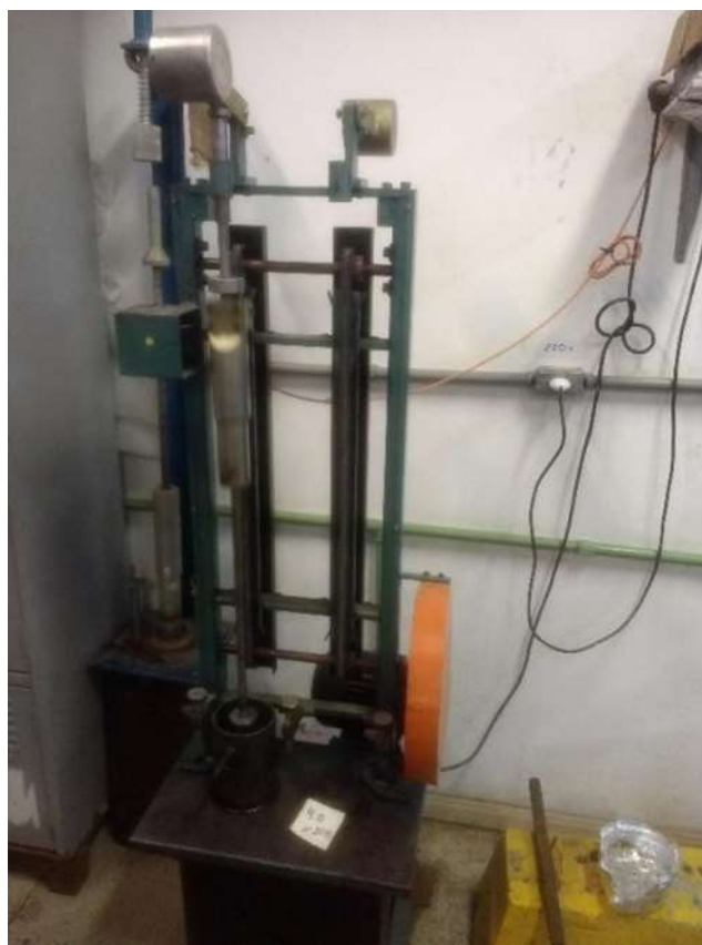
Figura 3.17 – Compactação do corpo de prova.
