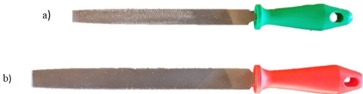
Figura 14 - Imagens das limas com cabo. Em a) lima enxada & multiuso de 8" da marca K&F e em b) lima chata bastarda de 10" da marca Wolker.
