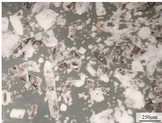
Figura 28 - Imagem das limalhas de magnésio após reagirem com solução de 5,0% em massa de NaCl por 36 horas obtida por microscopia óptica
