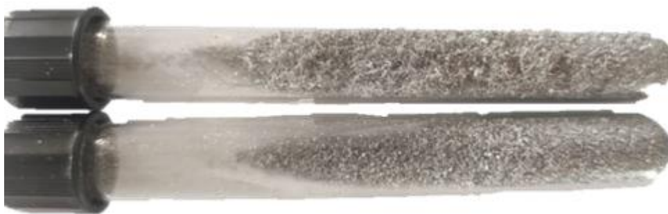
Figura 16 - -- Imagens das limalhas de magnésio armazenadas em tubo de ensaio com tampa
