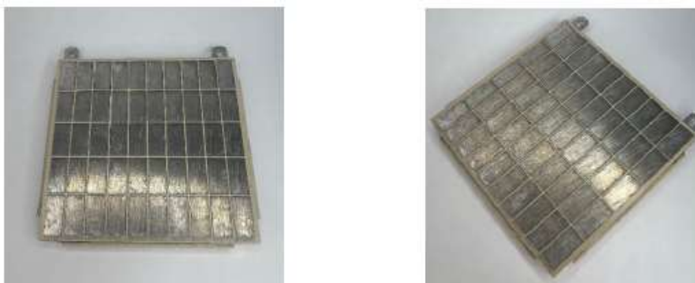
Figura 4.7 Módulo termoelétrico HZ-14 do fabricante Hi-Z technology
