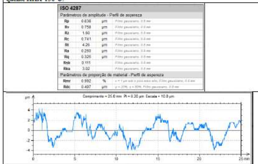
Figura G-6 Rugosidade longitudinal da superfície externa do permutador de calor da fonte quente HHX-150-U.
