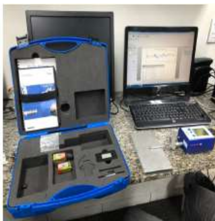
Figura 4.26 Rugosímetro portátil TAYLOR HOBSON modelo SURTRONIC 25 realizando teste de rugosidade transversal do permutador de calor HHX do TEGeA
