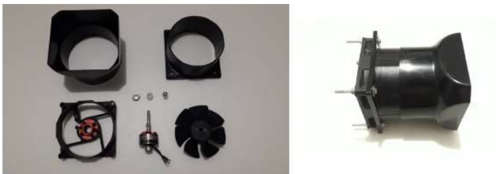
Figura 4.16 Componentes da seção de propulsão do ar do protótipo de gerador termoelétrico de exaustão automotiva (TEGea)
