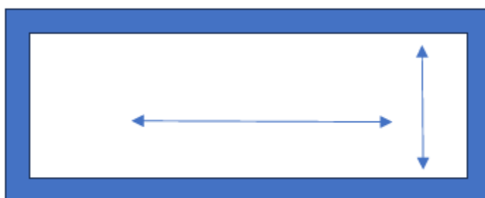
Figura 4.27 Teste de rugosidade na superfície externa dos permutadores de calor HHX com indicação da área dos módulos termoelétricos (circunscrita na cor branca) e direção longitudinal e transversal (setas azuis)
