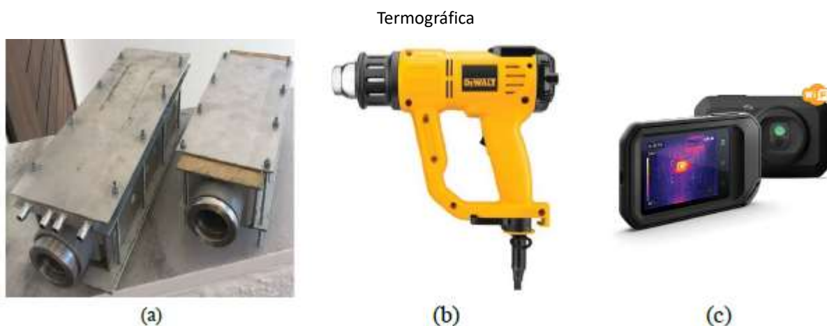
Figura 4.9 (a) Foto dos 02 primeiros protótipos de HHX (b) Soprador térmico e (c) Câmera
