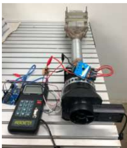
Figura 4.15 – Vista parcial da bancada experimental para teste do protótipo de gerador termoelétrico de exaustão automotiva (TEGea)
