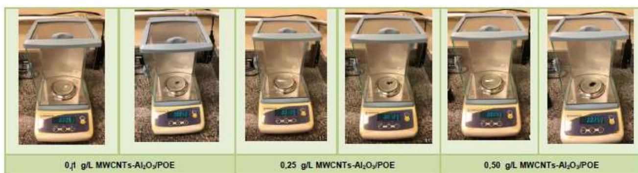
A Figura 3.5 – Medição das massas das nanopartículas de Al 2 O 3 e MWCNTs para diferentes amostras de nanofluido híbrido.
