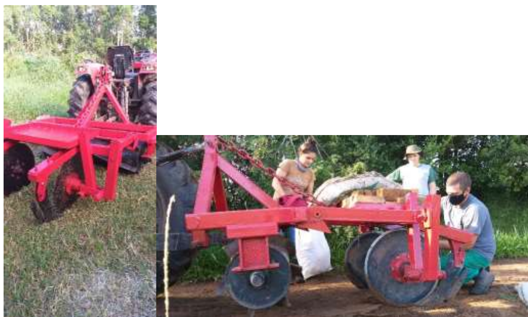
Figura 1: Implemento agrícola constituído de rolo-faca, discos de corte e sulcadores desenvolvido pelo Grupo de Pesquisa e Extensão SPDH/UFRGS, 2023. Foto: Tatiana Duarte
