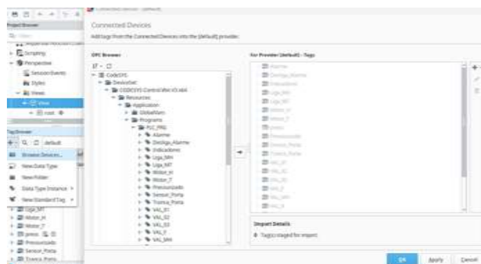
Figura 28 – Acesso das variáveis no Ignition através do servidor OPC UA
