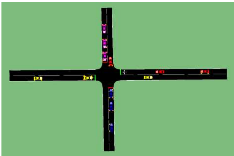
Figura 7 – Geometria do cruzamento bidirecional modelado no SUMO (4 abordagens, 1 faixa por sentido)
