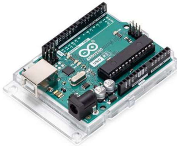
Figura 2 – Placa Arduino Uno, uma das versões mais utilizadas em projetos didáticos e de prototipagem (ARDUINO, 2025).
