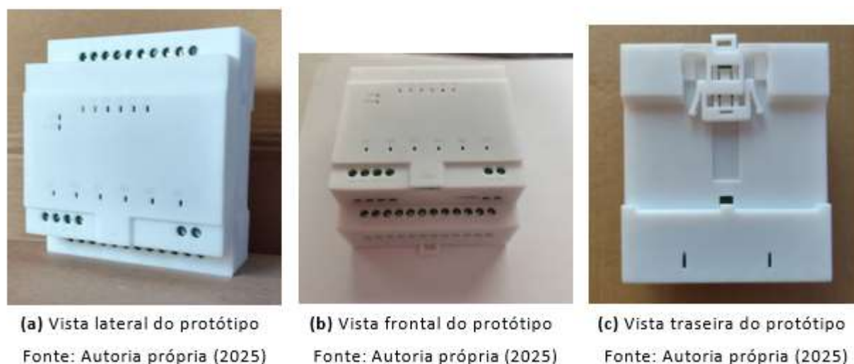
Figura 19 – Protótipo final montado em carcaça, com fixação em trilho padrão industrial.
