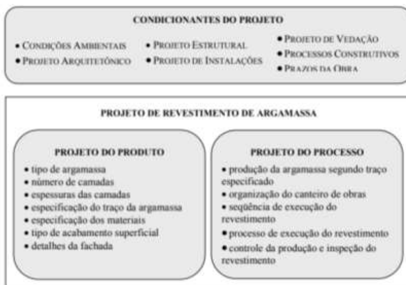
FIGURA 5 – Projeto de revestimento de fachada
