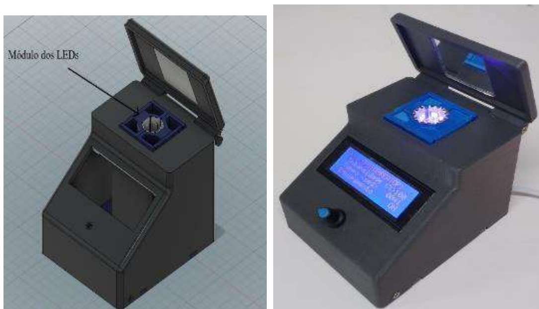
Figura 2. Fotorreator desenvolvido pelo software Fusion 360 da Autodesk. Em destaque a base de LEDs para um tubo de ensaio de 15 mL.
