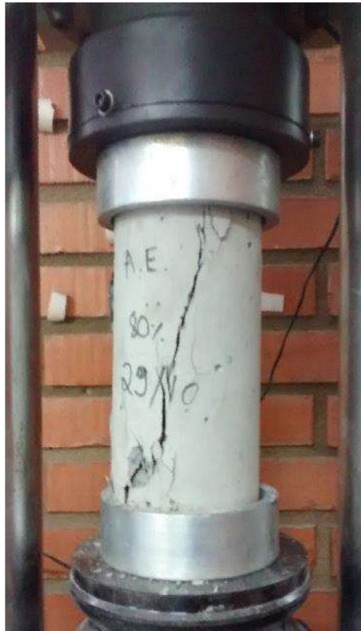
Figura 1- Corpo de prova rompido na máquina de ensaios.
