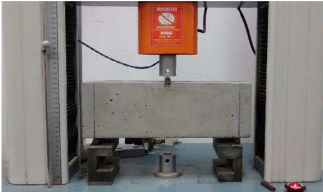
Figura 1- Viga submetida ao ensaio de flexão em três pontos.
