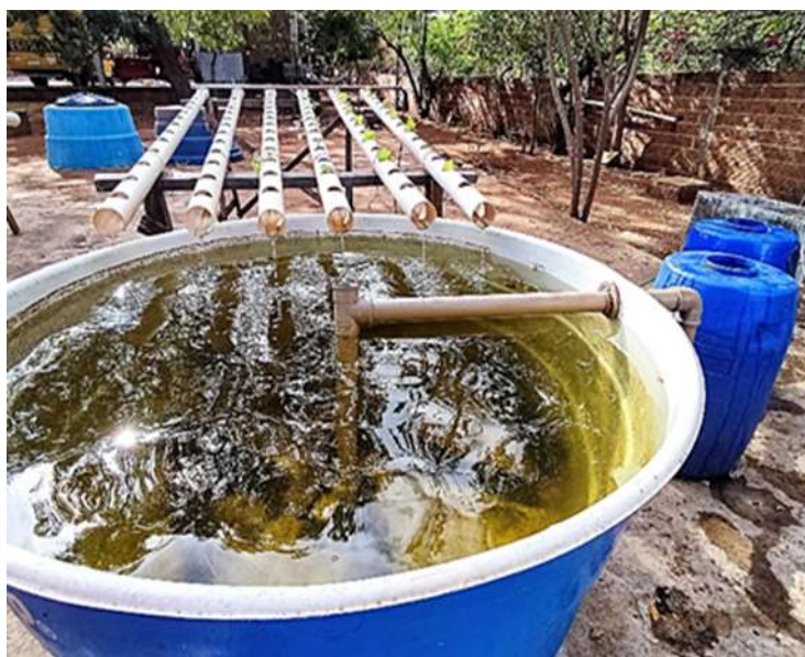
Figura 1 – Vista frontal do tanque de criação e das calhas do sistema educacional instalado na UAST-UFRPE em funcionamento.
