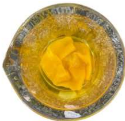
Figura 13 – Lavagem do tecido impregnado, imerso em água destilada.
