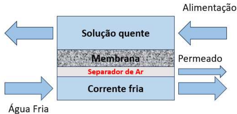
Figura 2.7: Destilação por Membrana com Separador de Ar (DMSA)
