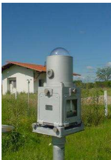
Figura 11. Actinógrafo (Foto: INPE).
