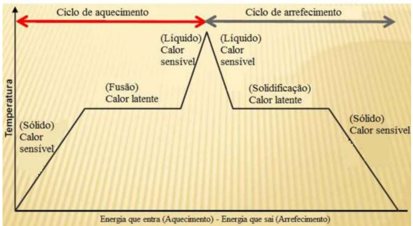
Figura 2: Curva teórica de calor latente para transição sólido/líquido
