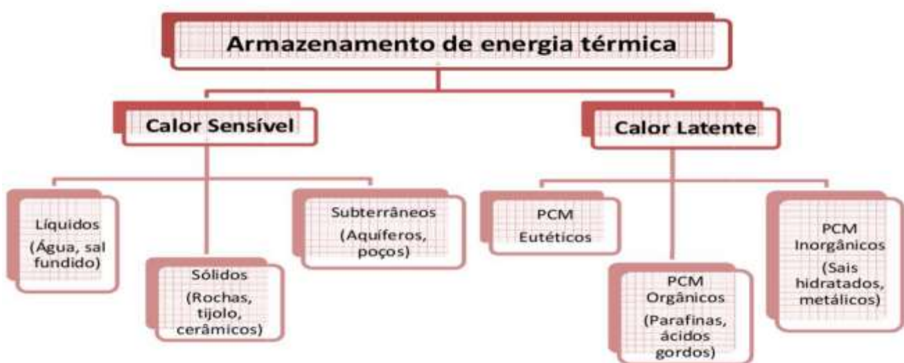
Figura 1 - Tipos de Armazenamento de Energia Térmica
