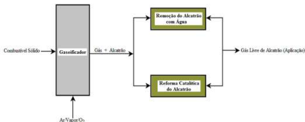
Figura 2.3: diagrama simplificado dos processos de remoção do alcatrão e da conversão catalítica do alcatrão (Devi, 2003)
