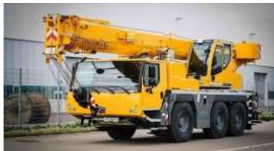
Figura 16 - Vidros em um guindaste móvel sobre rodas
