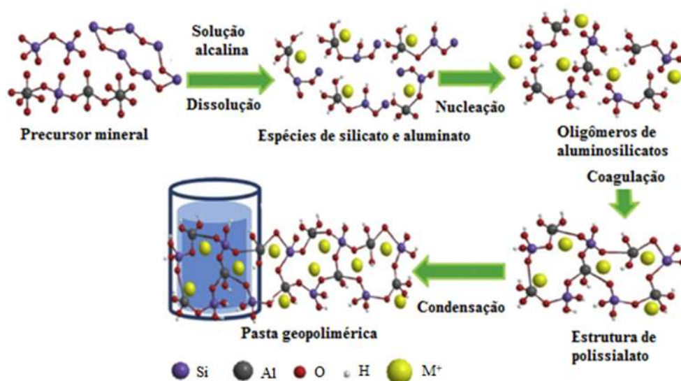
Figura 3 – Processo de síntese dos materiais álcali-ativados (ativação alcalina).
