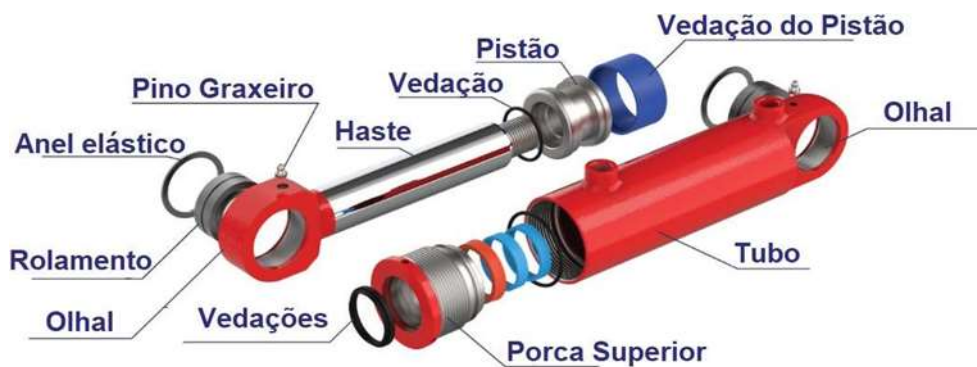
Figura 14 - Visão explodida de um cilindro hidráulico
