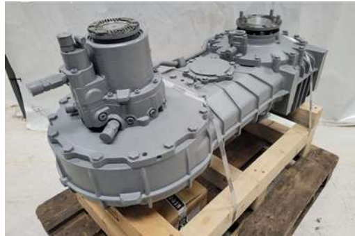
Figura 15 - Transmissão de um guindaste Liebherr
